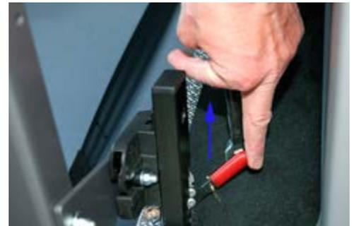
Die neuartige Rampenarretierung ermöglicht auch älteren Personen die Rampe mit geringem Kraftaufwand und einer Hand zu lösen.
